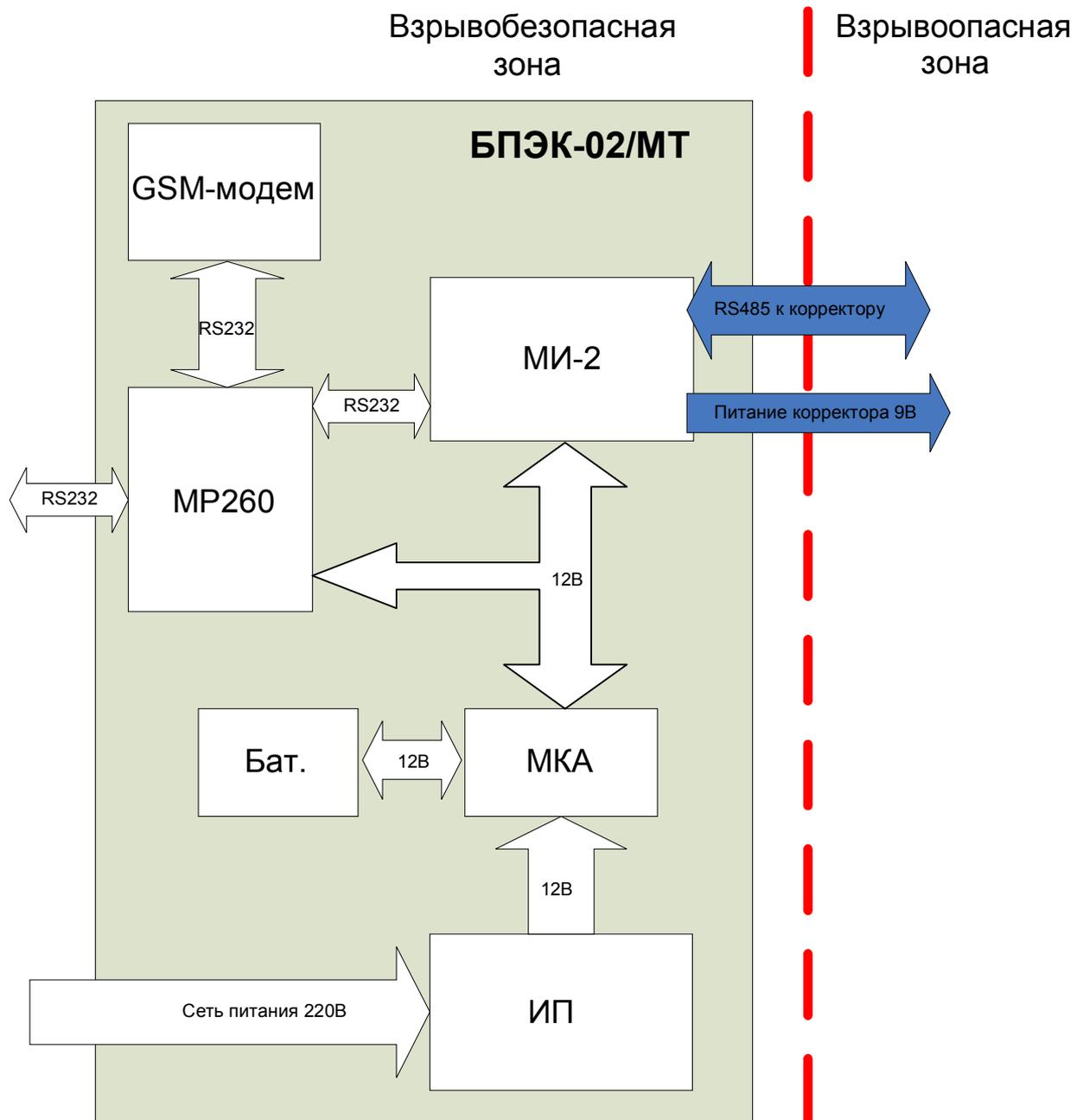
**Приложение В. Схема внешних соединений блока питания БПЭК-02/МТ**
